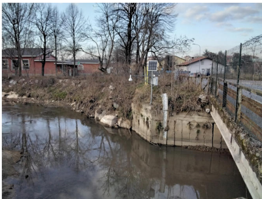
Figura 7: particolare dell'asta idrometrica utilizzata per la quotatura del rilievo topografico stato di fatto. L'asta è posizionata immediatamente a monte del ponte di via San Martino in corrispondenza della sezione idraulica 17_M
