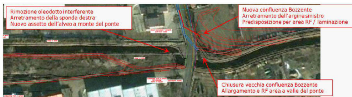
Figura 8: Immagine degli interventi previsti e realizzati nella zona di confluenza del torrente Bozzente in fiume Olona e nel tratto di alveo a monte di via S. Martino
